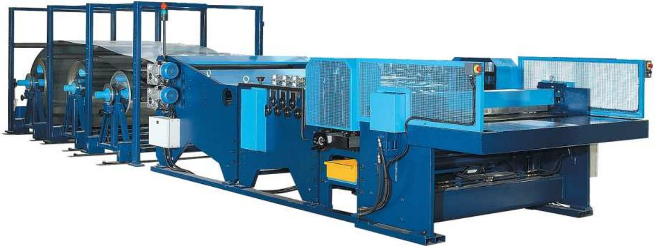
La linea e' composta da due moduli principali che sono la raddrizzatrice e il blocco taglia piega che comprende la cesoia e la piegatrice.
