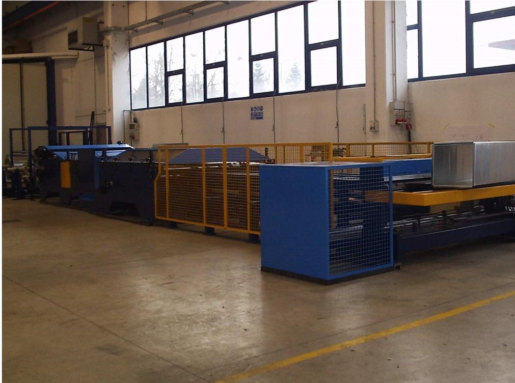
La linea e' composta da due moduli principali che sono la raddrizzatrice e il blocco taglia piega che comprende la cesoia e la piegatrice.
